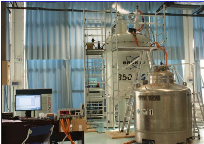
超导磁体 SM3 (配套核磁共振谱仪)
